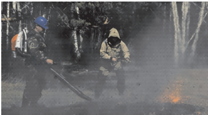
Рис. 3.13. Тушение пожара воздушным потоком (воздуходувка) и огнетушащим раствором (РЛО) по схеме тушения № 3 (фото А.В. Брюханова)
