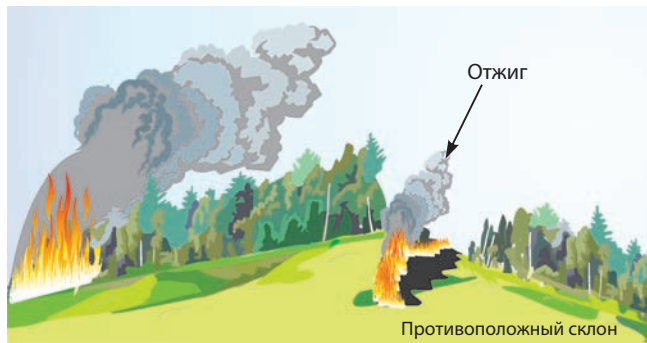
Рис. 3.25. Тушение пожара отжигом с противоположного склона (по Е.А. Щетинскому)
