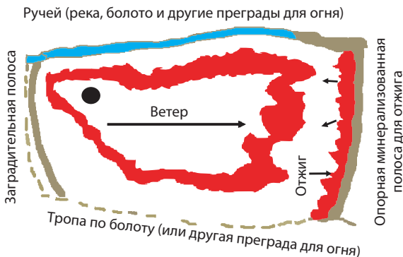
Рис. 3.14. Схема тушения лесного пожара отжигом
